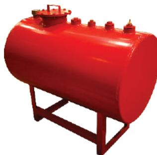
**Tanque externo:** Tanques de combustible construidos en acero a carbono, cubriendo la autonomía de volumen del incendio de los proyectos NFPA-20 (Norma Internacional) - NBR 10897 (Sprinklers) - NBR 13714 (Hidrantes) - norma 16704 , con respiro para seguridad del proyecto, incluyendo también el indicador visual y/o electrónico para accionamientos de alarmas en casos de nivel bajo (inferior a 50%), "exigencia NFPA-20". Opcional tanque de pared doble para instalación en ambientes confinados.
