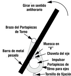
Figura 2. Aflojamiento del impulsor
