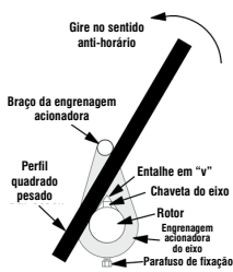
Figura 2. Afrouxamento do impulsor
