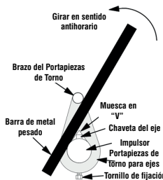
Figura 2. Aflojamiento del impulsor
