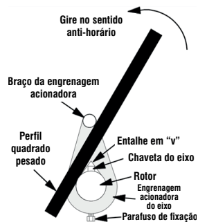
Figura 2. Afrouxamento do rotor
